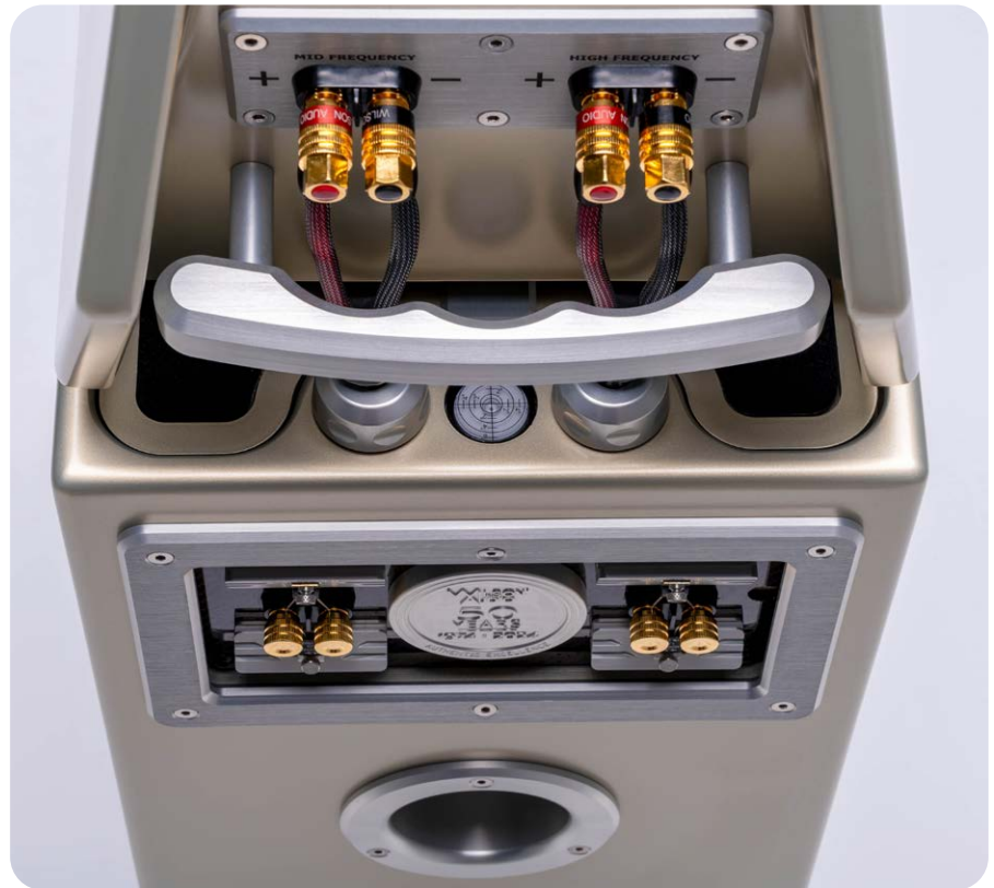
Die Weiche befindet sich im Puppy-Modul, oberhalb des Reflexports sind die Widerstände zu sehen, die eine Pegelanpassung erlauben (Bild: Wilson Audio)
